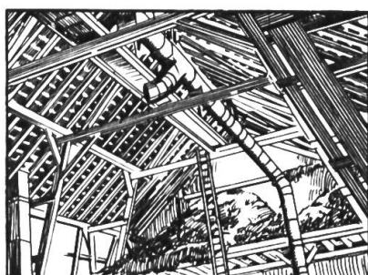
Fig. 7: L'engrangeur stationnaire A = Ventilateur B = Trémie d'alimentation C-D = Conduites E = Clapet de distribution fermé F = Clapet de distribution ouvert G-H = Coudes de distribution
