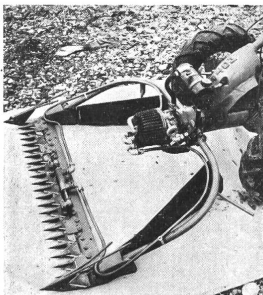
Dispositif d'entraînement hydraulique
