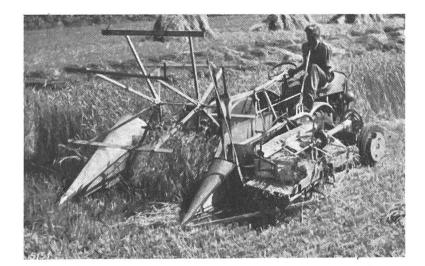
Fig. 3 Lieuse équipée d'une barre frontale en travail. Visibilité parfaite, maniabilité.
