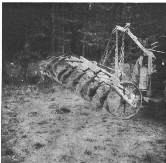
Fig. 7 Cultivateur trainé et avec relevage hydraulique.
