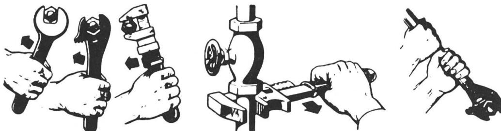
Employez des clés anglaises du type approprié, qui s'adaptent exactement. Tirez sur la clé dans le sens de la rencontre des mâchoires. Si la clé doit être poussée, mettez le bas de la paume de la main contre le manche pour protéger les doigts au cas où l'outil glisserait.
