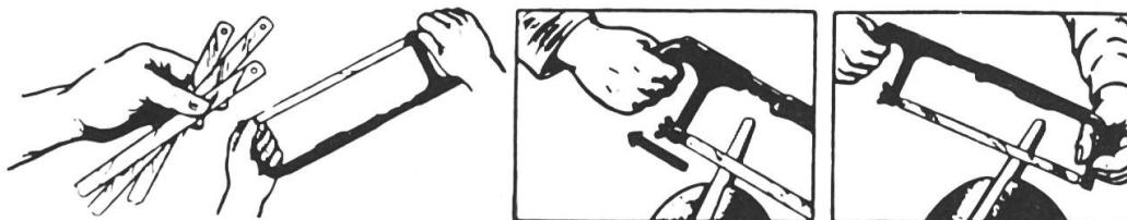
Utilisez des lames à grosses dents pour la matière dure et à dents fines pour la matière légère (environ 18 dents par pouce [25,4 mm] pour la besogne courante). Pointez les dents en avant et mettez-y de tension juste ce qu'il faut pour tenir la lame droite et l'empêcher de se fausser.
