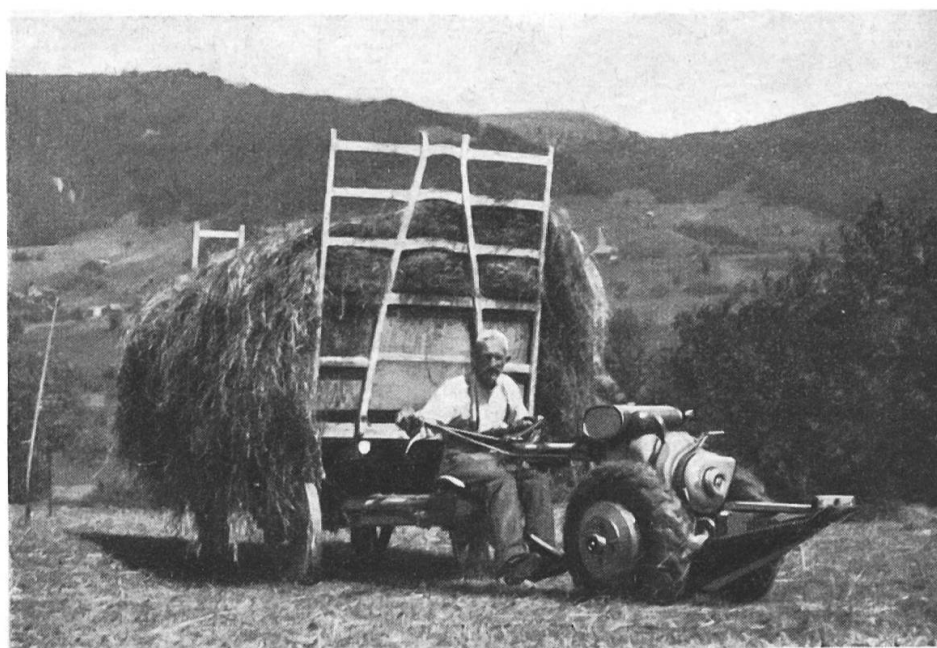
Fig. 9: Tracteur à un axe «Rapid S» remorquant un char de foin.
