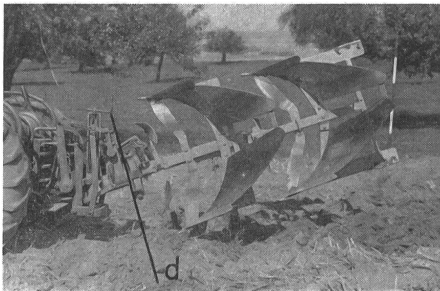
Fig. 13: Charrue double de Vogel et manivelle de terrage (d), permettant de régler en tout temps la profondeur du labour.
