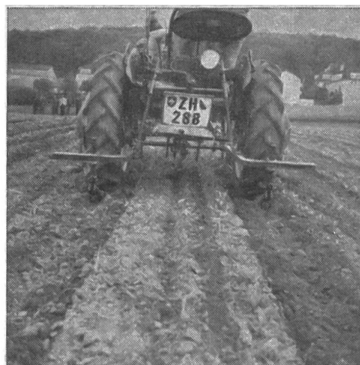
Fig. 1 b: «Farmall A» muni d'un dispositif pour ameublir la trace des roues.
