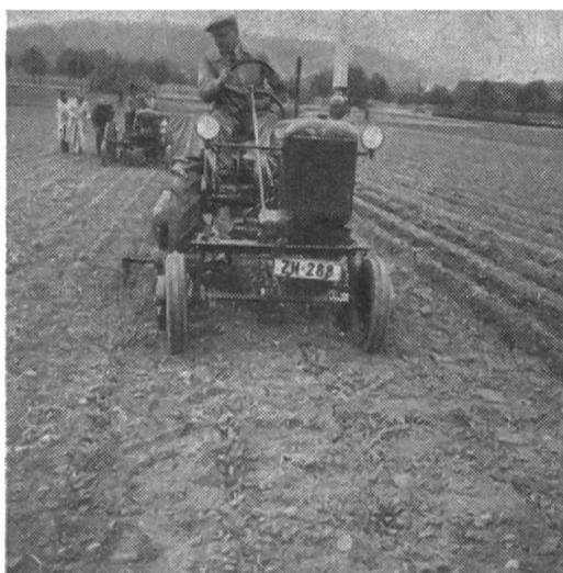
Fig. 2 a: «Farmall-Cub» sarclant des betteraves à sucre (4 rangs).
