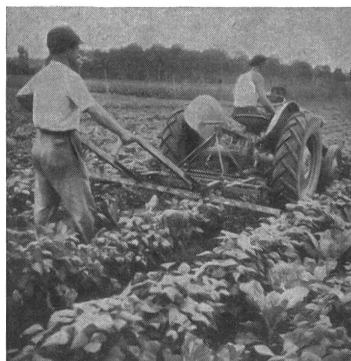
Fig. 2 b: «Farmall-Cub». La position du cultivateur.
