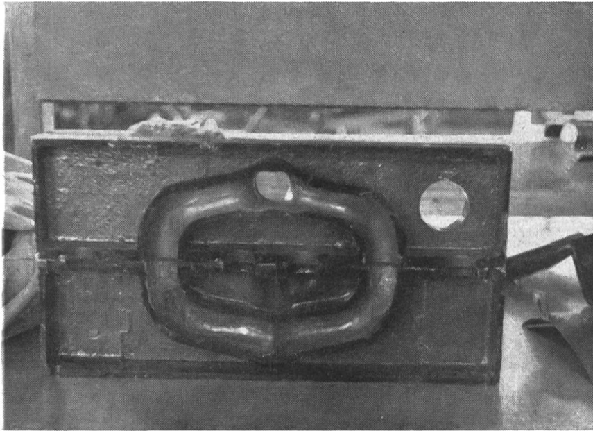
Fig. 65: Section d'un dispositif de réchauffage. Le conduit d'aspiration est entièrement noyé dans les gaz d'échappement.
