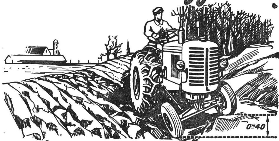
Le TRACTEUR RENAULT 22/30 CV conserve une **stabilité** absolue grâce à son essieu avant articulé qui assure le contact au sol des 4 roues malgré les obstacles.
