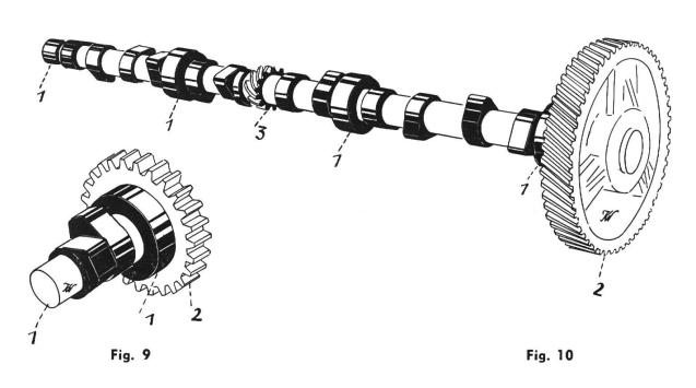
Fig. 9: Arbre à cames d'un moteur à 1 cylindre marchant lentement.
