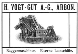
und 7.3 Meter breit. Es trug 80 Tonnen bei einem Eigengewicht von 30 Tonnen. Das 12 km/h schnelle Schiff war für den Kiesabbau bestimmt.<sup>240</sup> Die nächste Generation hatte bereits 100 Tonnen Nutzlast.<sup>241</sup> 1912 kam ein Exemplar für den Genfersee mit 120 Tonnen Nutzlast in die Fertigung. Dieses Exemplar war nun 33 Meter lang, die Ladevorrichtung vermochte die gesamte Nutzlast in zwei Stunden zu entladen.<sup>242</sup>
