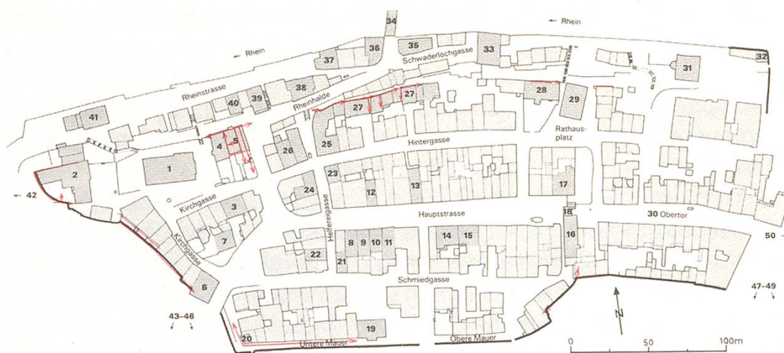
Abb.13. Plan der ältesten Stadtmauerteile (rot) mit Angabe der Stossrichtung bei Fugen (Pfeil).
