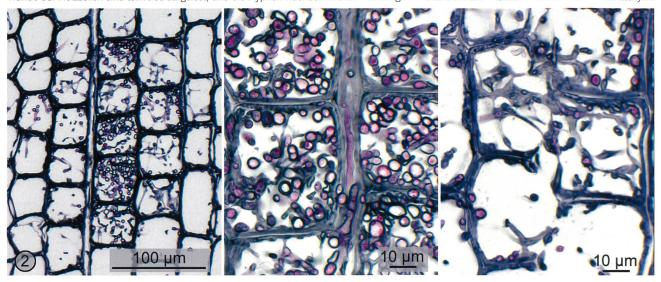
Abb. 3 Längsschnitte durch das weissfaule Fichtenholz. Im **Übersichtsbild** links sieht man einige längs geschnittene Holzzellen mit locker verteilten Pilzhyphen. Das **mittlere Bild** ist ein Ausschnitt aus dem Bild links und zeigt eine Schnalle (Pfeil). Das **rechte Bild** zeigt eine stark abgebaute Stelle im Holz. Die Wände der Holzzellen sind teilweise aufgelöst und die Hyphen wachsen in allen Richtungen. – Toluidinblau, Graustufen-Wiedergabe.
