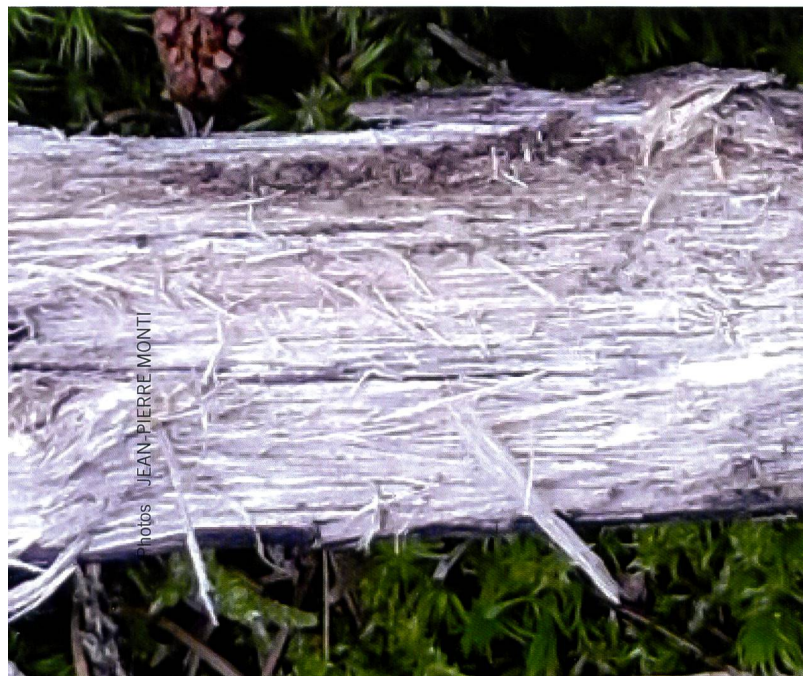
Fig. 5 Pourriture blanche | Abb. 5 Weissfäule
