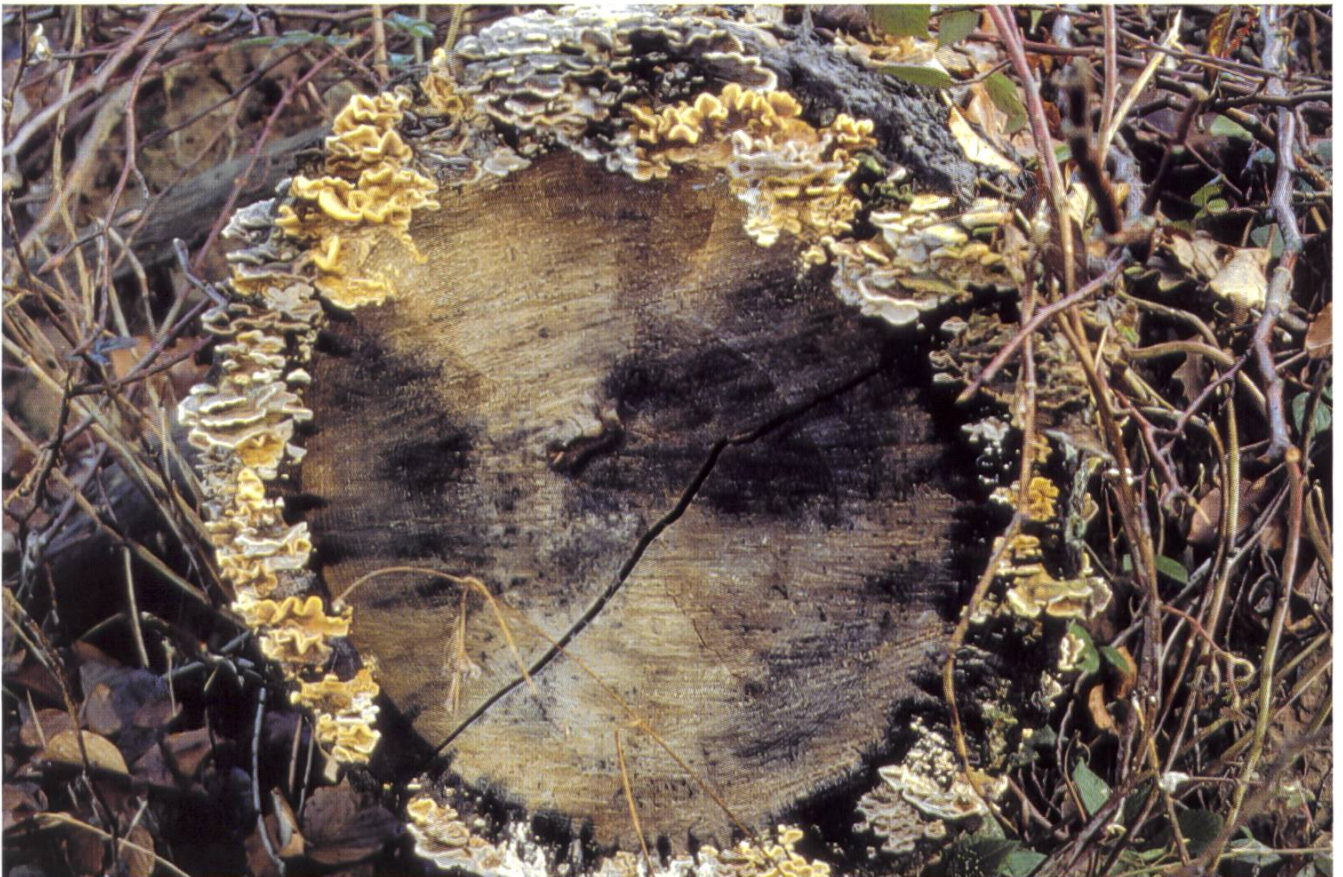
Bild Nr. 2: Bei der Eiche sieht die Sache anders aus. Zunächst wird der breitere Splintholz-Zylinder von den Pilzen besiedelt und abgebaut. Das Kernholz ist durch Einlagerung von Pilzbefall hemmenden Substanzen (Harze, Öle, Tannine usw.) so resistent, dass es von aussen her nur ganz langsam, fast jahringweise, aufgelöst wird.
