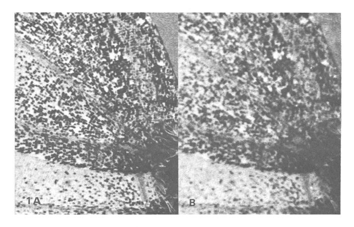
Figuren 1a und b: Ausschnitt aus dem Flügel eines Kohlweisslings, fotografiert mit einer Hasselblad im Massstab 1:1,4, nachvergrössert auf 11,5:1. Beide Bilder bei gleicher Scharfeinstellung! Bild a wurde mit Blende 5,6 aufgenommen, Bild b mit Blende 45. Die starke Abblendung in Bild b hat eine dramatische Verschlechterung des Auflösungsvermögens zur Folge.
