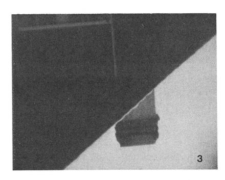
Dasselbe Objekt mit einem etwas weniger gut korrigierten Kondensor längerer Brennweite.
