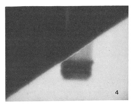
Dasselbe Objekt mit einem schlecht korrigierten Kondensor abgebildet. Die Unschärfe ist nicht durch falsches Einstellen, sondern durch ungenügende Qualität des Kondensors entstanden.
