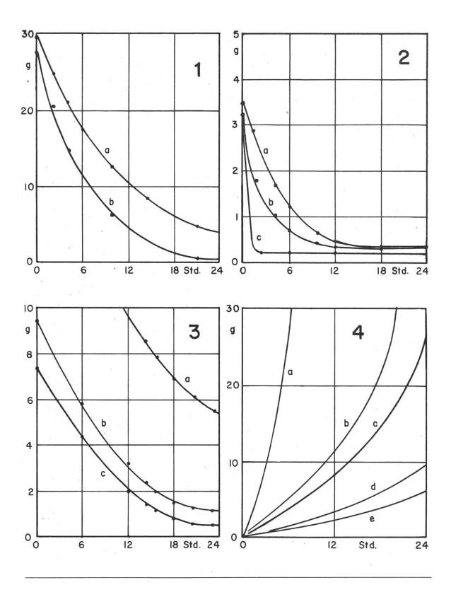
Die Spanne zwischen den Kurven a und e zeigt, wie sehr variabel die Trocknungszeit für die gleiche Pilzmenge sein kann, je nachdem die spezifische Oberfläche groß oder klein ist.
