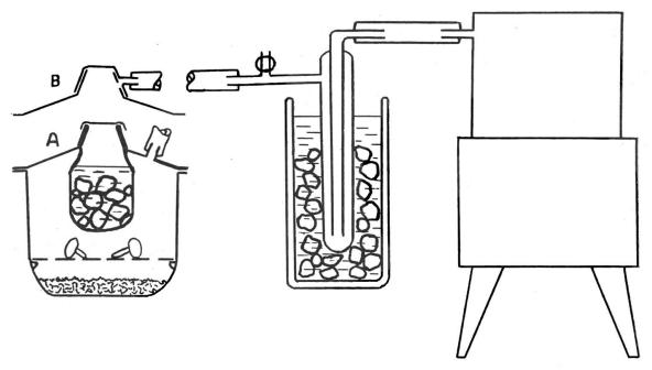
Abb. 2. Kombinierte Anlage mit Kältefinger und Silicagel.
