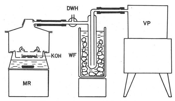
Abb. 1. Anlage mit Schwefelsäure und Kaliumhydroxyd.
