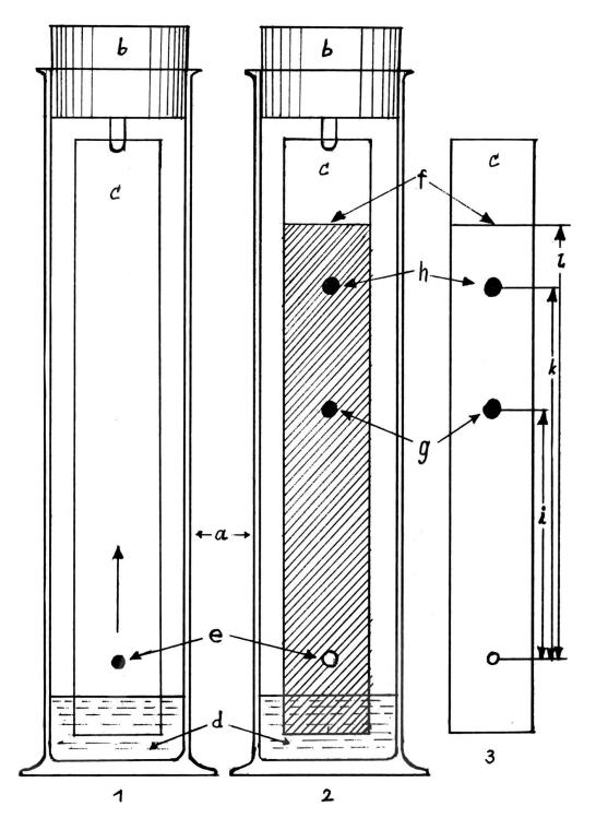
Schematische Darstellung der aufsteigenden Methode
