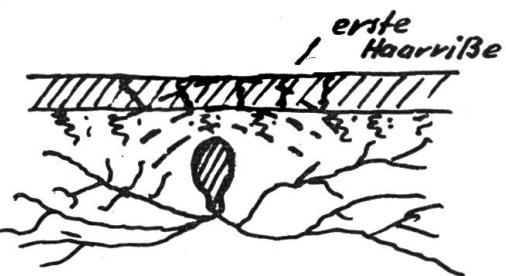
Im Fruchtkörper entsteht Druck der ständig höher wird um die Aufwölbearbeit vollbringen zu können.
