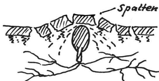
Die Rille im Makadam werden immer größer, erweitern sich zu Spalten. der Erddruck wird immer geringer
