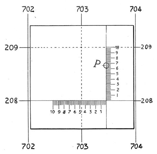
west-Ecke jedes Quadrates. Mittelst eines Planzeigers, siehe Abbildung, kann jeder Punkt innerhalb eines solchen Quadrates, der einer Fundstelle entspricht, durch Ordinate und Abszisse mit einer für unsere Zwecke genügenden Genauigkeit bestimmt werden. Dieser Planzeiger ist eine durchsichtige Cellonschablone, welche rechts unten zwei in einem rechten Winkel zueinander stehende Skalen trägt. Die Skalalänge entspricht der Seitenlänge eines Kilometer-Quadratnetzes, bezw. zwei
