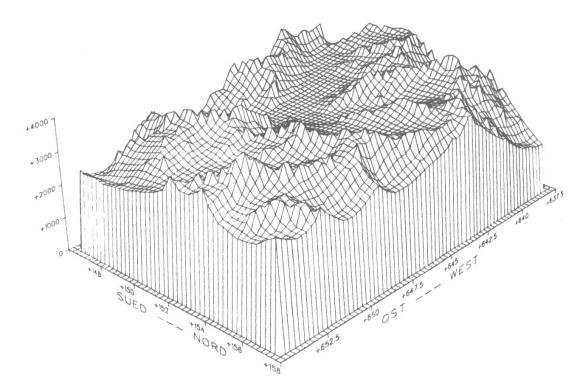
Abb. 1: Panoramische Visualisierung eines Ausschnitts des Rimini-Modells (Konkordiaplatz und Umgebung). Es zeigt die Anordnung von Punktdaten unterschiedlicher Höhe in einem Quadratgitternetz (Dokumentensammlung swisstopo (im Folgenden DSS), 3201-01 RIMINI, Orientierung über digitale Geländemodelle. Projekt RIMINI. GRD, Dezember 1979, Abb. 7).
