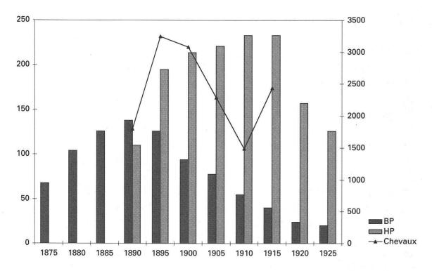
Graphique 3. Axe de gauche: nombre de moteurs hydrauliques à basse et haute pression installés à Genève. Axe de droite: puissance installée en chevaux (Source: Piguet François, L'industrialisation de Genève au XIX<sup>e</sup> siècle: l'eau motrice, une forme originale de transmission de l'énergie, mémoire de licence, Genève 1977, annexes 12 et 13).
