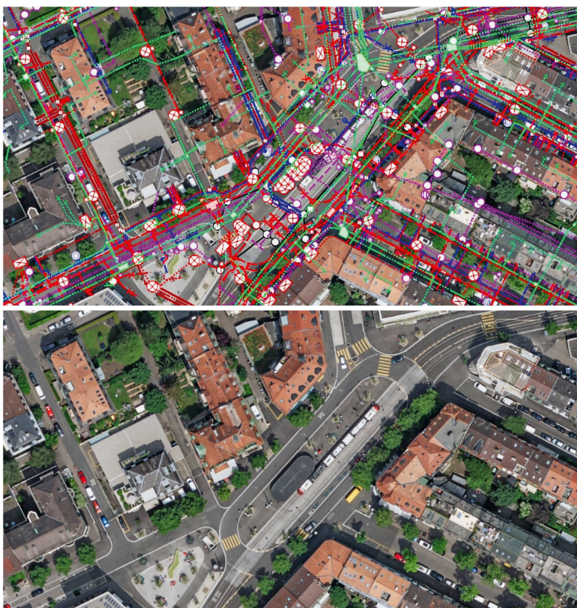
Abb 3 Am Breitenrainplatz in Bern sorgt die intensive Beanspruchung des Untergrundes durch Versorgungs- und Mobilitätsinfrastruktur für eine herausfordernde Ausgangslage hinsichtlich Baumpflanzungen. Quelle: Amt für Geoinformation des Kantons Bern 2023
