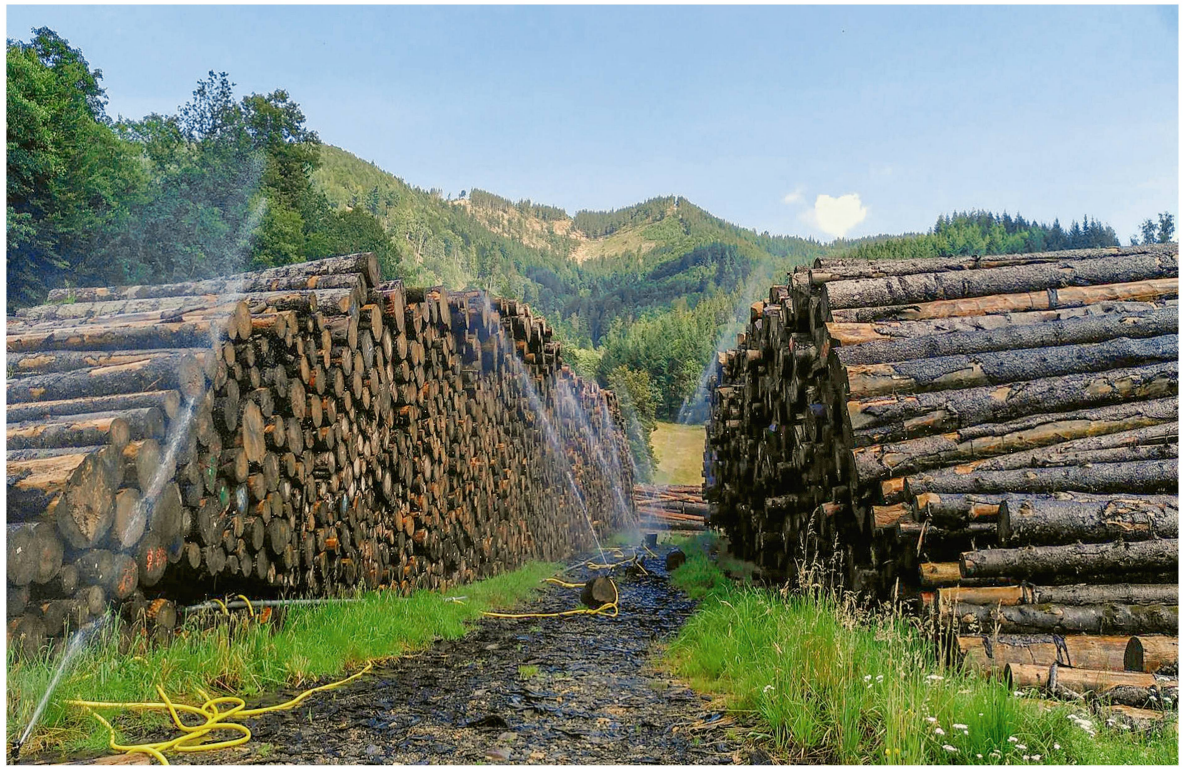
Fig. 1 Les scieries doivent gérer l'offre excédentaire. P. ex. grâce à un stockage humide, comme en Forêt-Noire. Photo: J. Schweier
