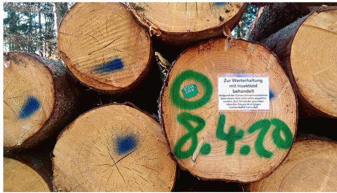
Mit Insektizid behandeltes Rundholz. Bild: Vera Grubenmann, BFH-HAFL
