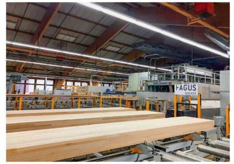
Production d'éléments collés en hêtre pour la construction en bois. Photo: Fagus Suisse
