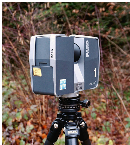
Abb 1 Der an der WaPlaMa-Jahrestagung prä-sentiertere terrestrische Laserscanner. Foto: Barbara All-gaier Leuch
