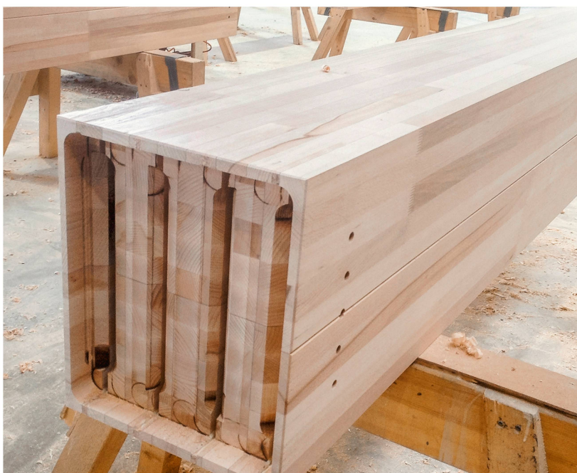
Abb 2 Stützen aus Buchenholz mit einer Festigkeit von 3000 kN werden schon bald bei der Fagus Suisse SA serienmässig produziert. Foto: Fagus Suisse SA
