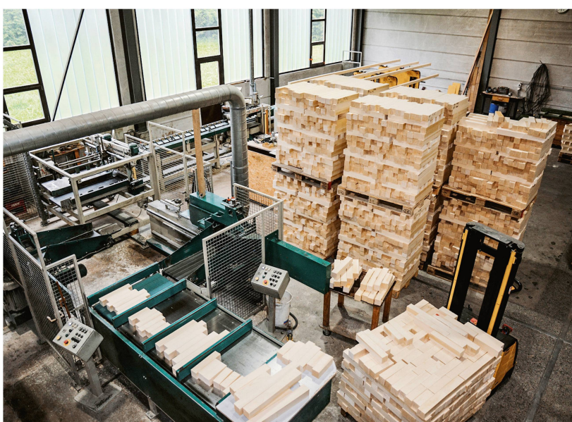
Abb 6 Produktion von homogenem Qualitätsholz mit einer Kurzholz-Keilzinkanlage bei Brühwiler Sägewerk AG, Wiezikon. Foto: Brühwiler Sägewerk AG
