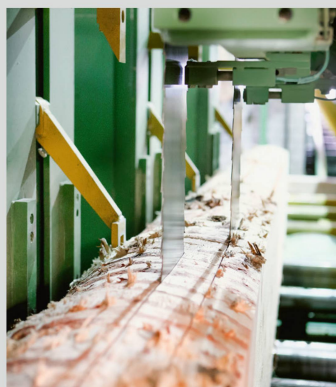
Starkholzeinschnitt mit moderner Bandsäge bei OLWO/Worb. Foto: OLWO
