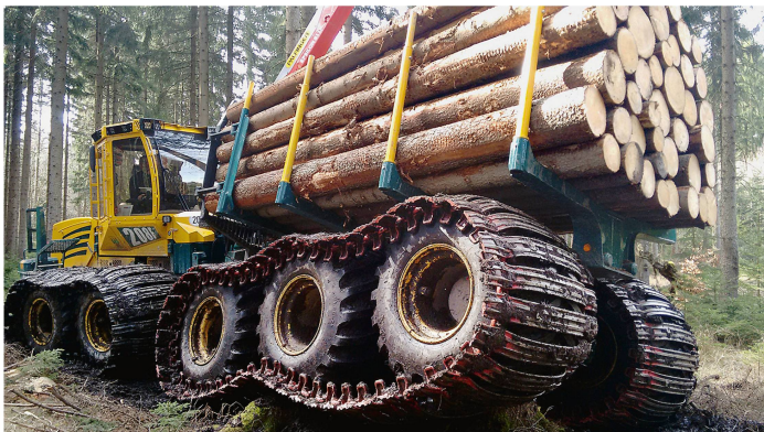
Abb 1 Triple-Bogie-Achse im Härtestest.
