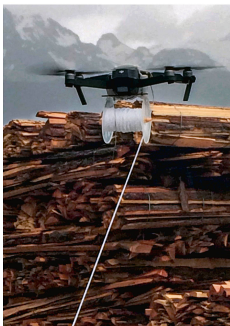
Fig. 1 Drone portant la bobine de fil. Photo: François Sandmeier
