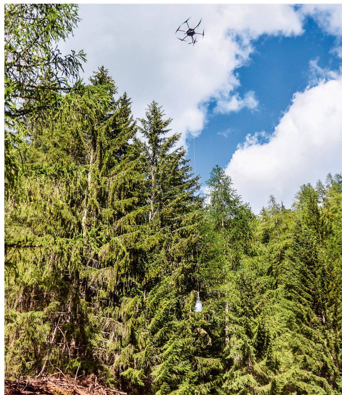
Fig. 3 Essai complémentaire de transport de matériel avec un drone plus puissant de la marque TTA M6FA. Photo: Forêt Valais
