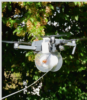
Drone DJI Mavik Pro tirant la «ficelle» lors d'un essai de montage de ligne de câble forestier aérien. Photo: Forêt Valais
