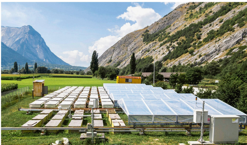
Abb 1 Regendachanlage am Fuss der Walliser Felsensteppe in der Nähe von Leuk.
