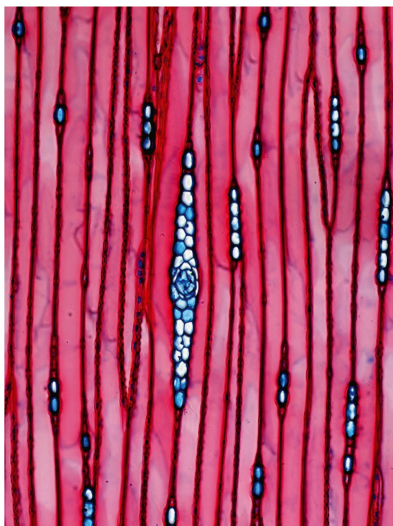
Abb 10 Tangential-schnitt durch das äussere Xylem einer Waldföhre. Sichtbar sind die axialen Tracheiden (rot) und die radialen Markstrahlen (blau/weiss). In der Bildmitte befindet sich ein mehrreihiger Markstrahl mit einem Harzkanal.
