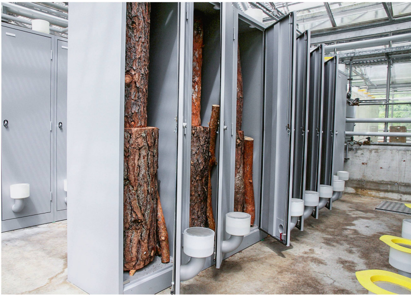
Abb 3 In sogenannten Fotoelektoren wurden Stamm- und Aststücke zum Ausbrüten von Insekten inkubiert. In die geschlossenen Schränke fällt Licht nur über die unten und oben angebrachten Fangdosen. Die ausgeschlüpften Insekten streben zum Licht und können in den Dosen abgesammelt werden. Foto: Beat Wermelinger
