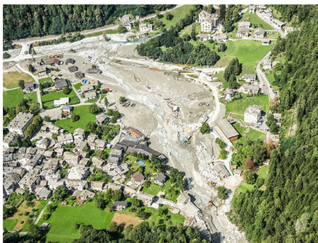
Fig. 1 Vue aérienne sur la localité de Bondo, où des laves torrentielles ont rempli le bassin de retenue et ont endommagé des bâtiments et infrastructures. Photo: VBS Le service de vol de swisstopo
