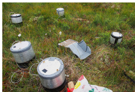
Abb 2 Messhauben zur Messung von Treibhausgaskonzentrationen.
