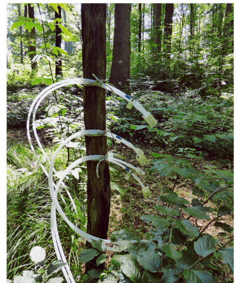
Abb 5 Anlage zur Messung der Waldgesundheit (Lisimeter) auf einer Forschungsfläche in Muttenz. Foto: Institut für Angewandte Pflanzenbiologie IAP
