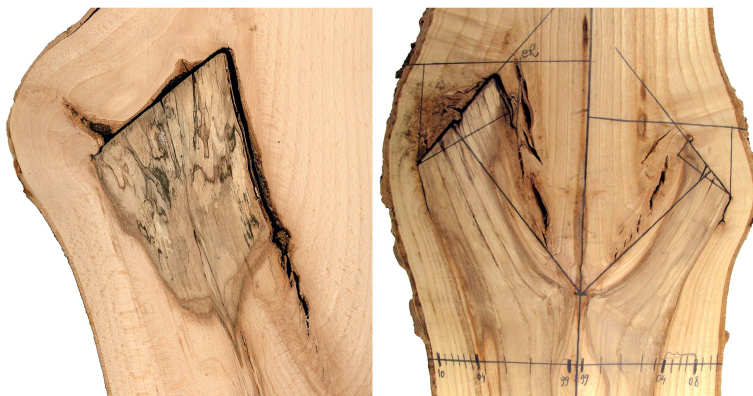
Abb 2 Im Astholz einer Buche eingeschlossene Weissfäule nach Grünästung (Astdurchmesser 60 mm; links) und Stammverfärbung an einer Esche nach Grünästung mit eingezeichneten Messlinien (Astdurchmesser 47 und 33 mm; rechts).
