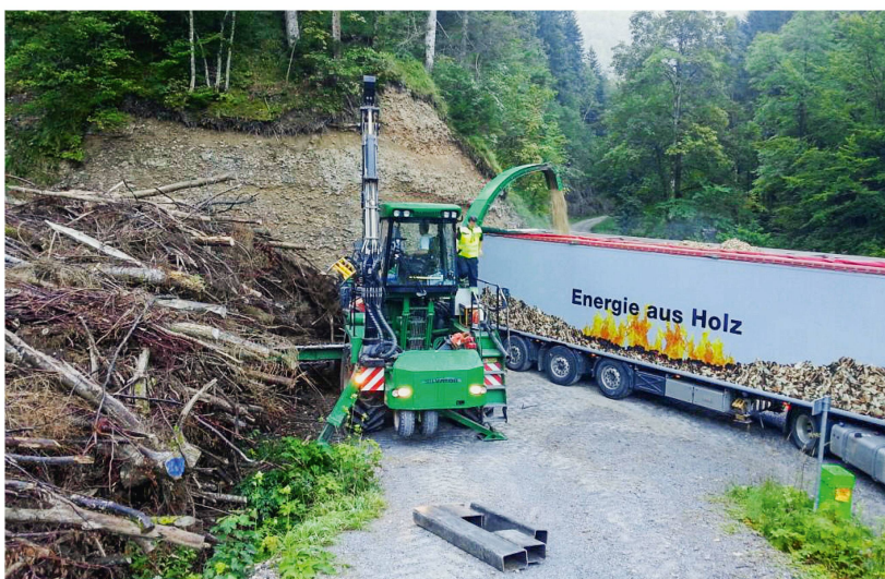
Abb 2 Bei der Holzernte gilt es, das leistungsfähigste Verfahren zu wählen. Im Bild dargestellt ist die durchoptimierte Prozesskette für die Hackschnitzelaufbereitung in steilem Gelände. Foto: Zürich Holz AG
