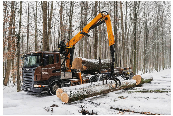
Abb 3 Gut ausgebaute Waldstrassen im Mittelland sind auf Fahrzeuggespanne ab 40 t Gesamtgewicht (in der Regel 5 Achsen) dimensioniert und haben eine Breite von 3.5 m und mehr. Foto: Paul Rienh
