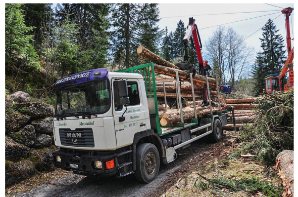
Abb 1 Die Waldstrassen der LFI-Zeitreihe weisen eine Mindestbreite von 2.5 m auf, sind für Achslasten von 10 t dimensioniert und damit allesamt für Fahrzeuge wie im Bild befahrbar.
