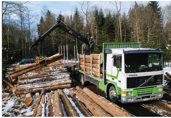
Abb 2 Die vom BAFU definierte Mindestbreite einer Waldstrasse beträgt 3 m und die Strasse soll mindestens für Fahrzeuggespanne von 28–32 t befahrbar sein. Foto: Paul Rienh
