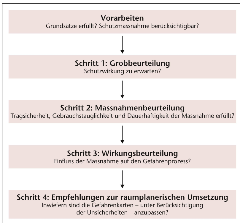
Abb 1 Das Vorgehen zur Beurteilung von Schutzmassnahmen nach Protect. Quelle: Romang et al (2008), vereinfacht. Auf den Schutzwald angewendet werden im Rahmen des Projekts Protect-Bio die Schritte 1 bis 3, nicht aber Schritt 4.
