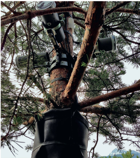
Station de mesures à Salquenen/VS 2013: caméra réseau et capteur ultrason sur un pin sylvestre.
