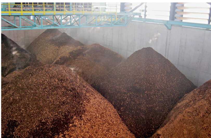
Abb 1 Blick in die Lagerhalle in Aubrugg mit den rauchenden Energieholz-Schüttkegel.
