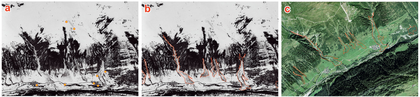
Abb 7 Lawinenniedergänge Bedrettotal, Villa Bedretto (TI). a) Originalbild vom April 1986 mit Passpunkten, b) Originalbild mit digitalisiertem Ablagerungsperimeter, c) Orthofoto mit digitalisiertem Ablagerungsperimeter. Trotz Flugaufnahme konnte der theoretische Kamerastandort bestimmt und das Bild entsprechend georeferenziert werden.
