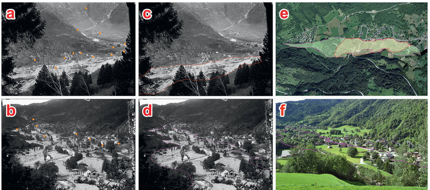
Abb 5 Fallbeispiel Hochwasser in Sommascona, Olivone (TI). a) und b) Originalbilder vom September 1927 mit Passpunkten, c) und d) Originalbilder mit digitalisiertem Ablagerungsperimeter, e) Orthofoto mit digitalisiertem Ablagerungsperimeter, f) Projektion des Ablagerungsperimeters auf eine aktuellen Aufnahme. Dank den von unterschiedlichen Standorten aus aufgenommenen Bildern war es möglich, das Ablagerungsgebiet fast vollständig zu erfassen. Dazu wurden die Polygone der einzelnen Bilder vereint.
