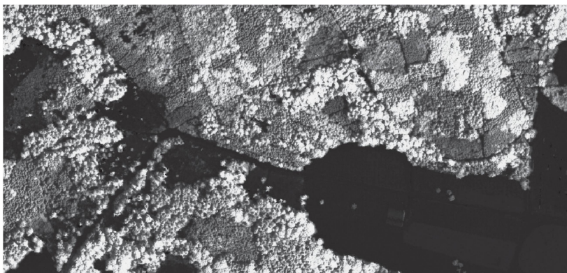
Abb 6 Erhöhung des Informationsgehalts der Fernerkundungsdaten durch Multiplikation des Kronenhöhenmodells mit dem Nahinfrarotkanal als Möglichkeit zur Unterscheidung von Laub- und Nadelgehölzen.
