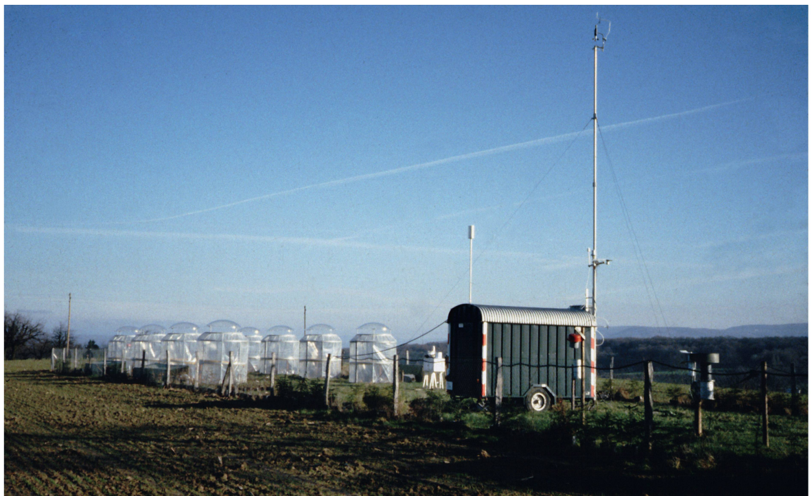
Abb 1 Begasungsanlage in Schönenbuch (Open-Top-Kammern mit gefilterter und nicht gefilterter Luft).
