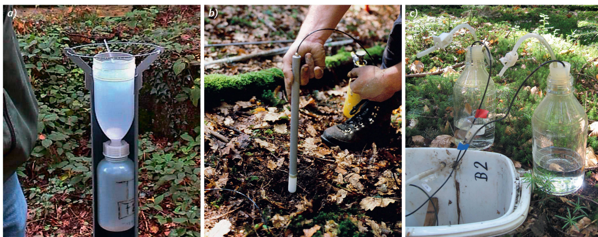
Fig. 3 Collecteur de pluie (a), installation d'un lysimètre sous-tension avec bougie en céramique (b) et échantillons de solution du sol (c).
