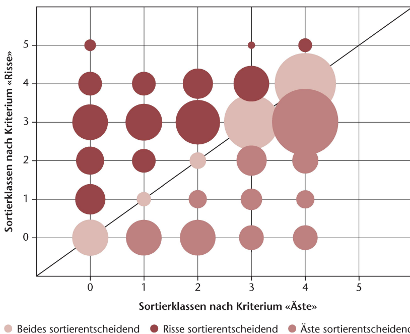
Abb 7 Wirksamkeit der Sortierkriterien Äste und Risse bei der Sortierung nach DIN EN 1611-1:2002. Ein Rasterpunkt zeigt, in welche Klasse ein Schnittholz (n=437) aufgrund des jeweiligen Kriteriums einsortiert würde. Bei den Punkten entlang der 45°-Achse führen beide Kriterien zum selben Ergebnis. Bei den darüberliegenden Punkten sind Risse das entscheidende Kriterium, bei den darunterliegenden sind es Äste. Die Grösse der Punkte gibt die Anzahl wieder (kleinster Punkt: 1 Probe, grösster Punkt: 63 Proben).
