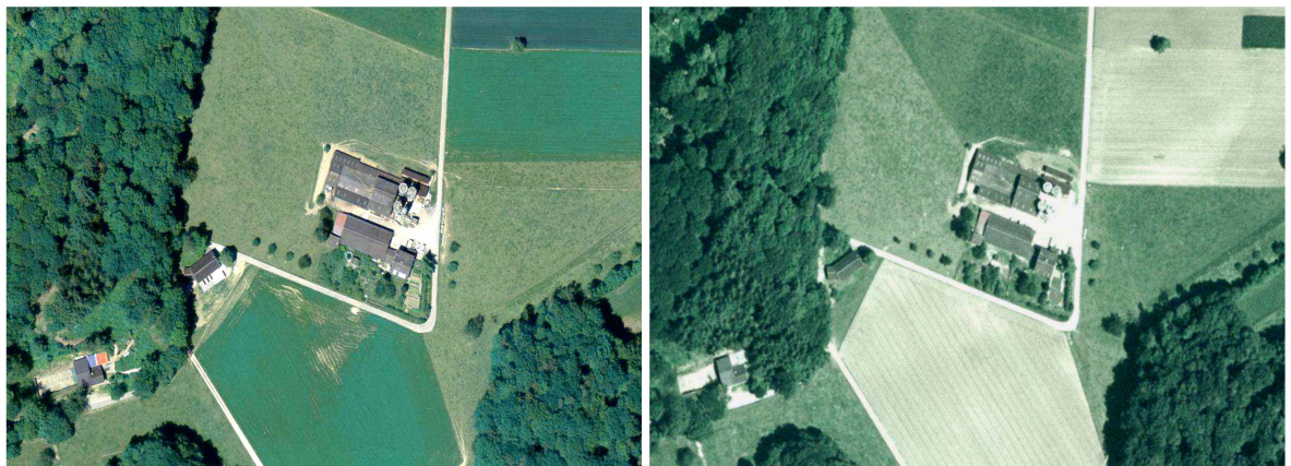
Abb 2 Digitale Luftbildaufnahme (swissimage Level 2, ADS40, 25 cm, SH; links) und analoges Luftbild (swissimage Level 1, RC30, 50 cm, SH; rechts). swissimage © 2011 swisstopo (BA 110136)
